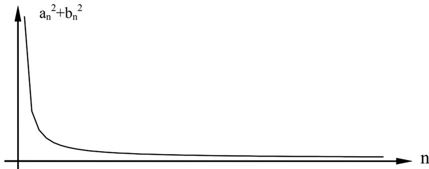
Ilustración II-11: Coeficientes de la descomposición de una onda cuadrada
